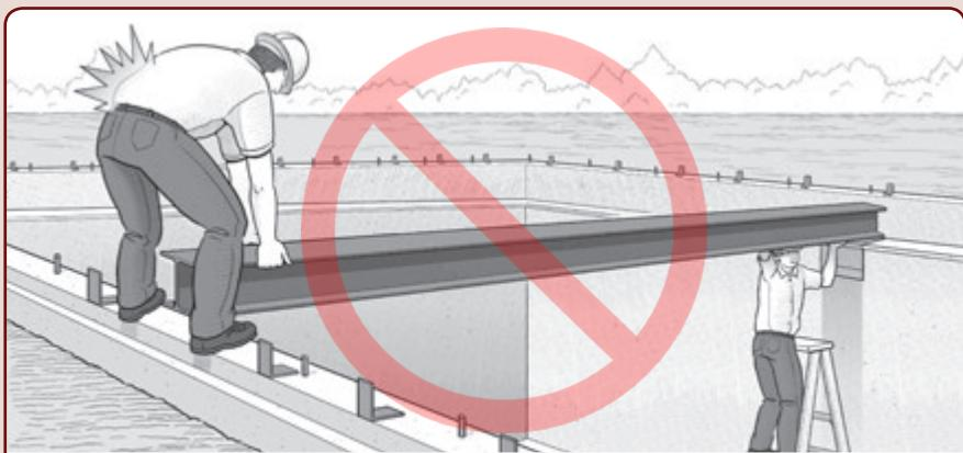
Colocar una viga-I con las manos a través de una pared de cimiento puede resultar en un daño que cause discapacidad o muerte.
