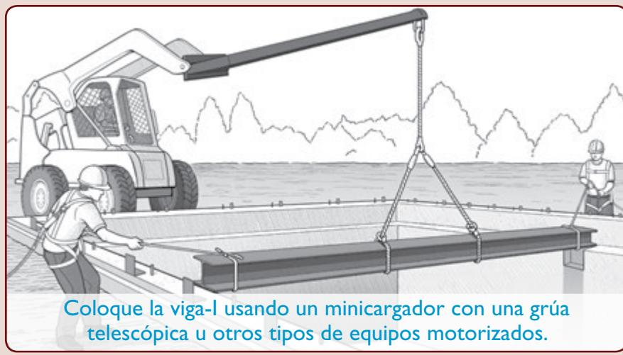
Coloque la viga-I usando un minicargador con una grúa telescopica u otros tipos de equipos motorizados.
