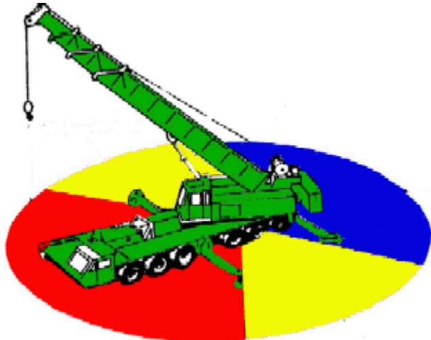
**AREA DE TRABAJO (AT) :** AREA MEDIDA EN UN ARCO CIRCULAR SOBRE EL EJE DE ROTACION DE LA TORNAMESA COMO SE MUESTRA EN EL AREA DEL DIAGRAMA DE OPERACIÓN.
